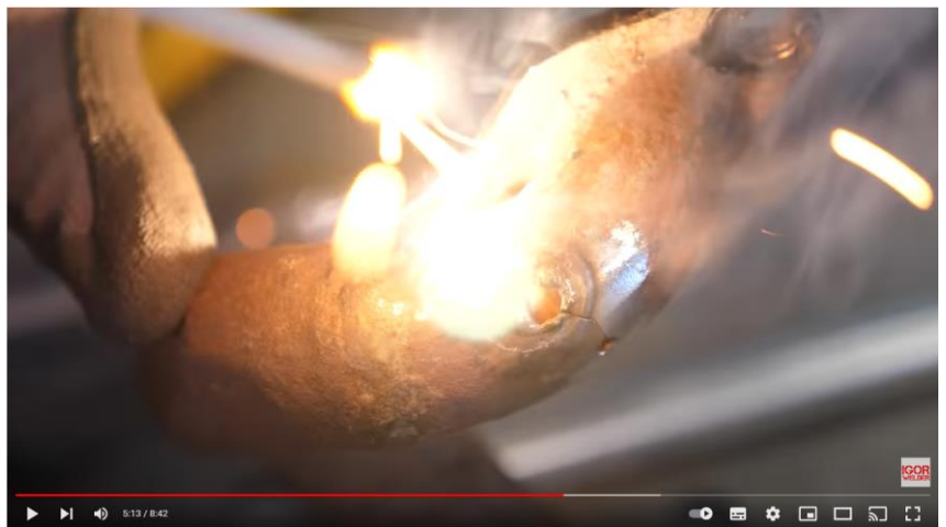
Roller Auspuff mit Elektrode schweißen! | Geheimtipp ohne Durchbrennen
